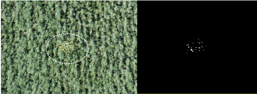
Figura 17. Parte del ortomosaico generado a partir del vuelo con la cámara RGB Sony el 1 de junio de 2022 de la parcela 38-12-503. A la izquierda, imagen original. A la derecha, imagen resultante de la aplicación de un valor umbral combinado a las componentes H y S resultantes de la transformación RGB - HSV.
