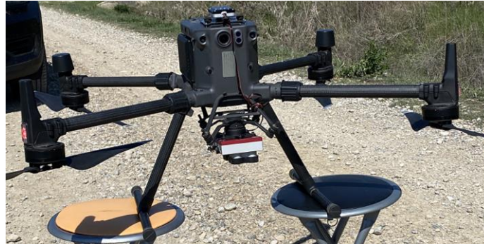
Figura 5. Imagen del dron Matrice 300 con la cámara RedEdge-MX Dual de MicaSense acoplada.
