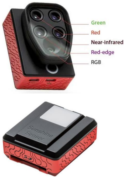
Figura 1. A la izquierda, imagen de los dos sensores que componen la cámara Sequoia de Parrot (dimensiones máximas de 59mm x 41mm x 28mm). A la derecha, bandas espectrales en las que trabaja.
