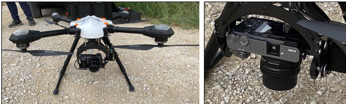
Figura 3. A la izquierda, imagen del dron AERIS ONE al que se acoplan las cámaras RGB Sony A6000, a la derecha, y Parrot-Sequoia.
